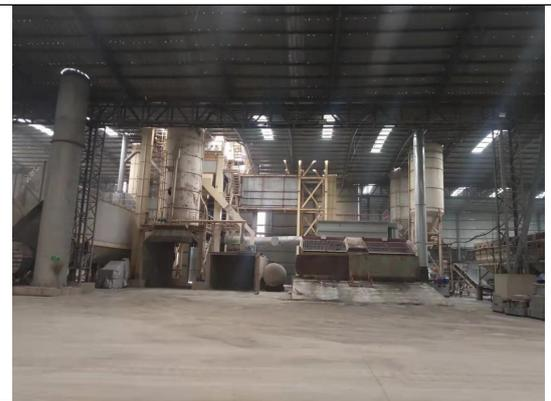
沥青混凝土和路基材料生产线
