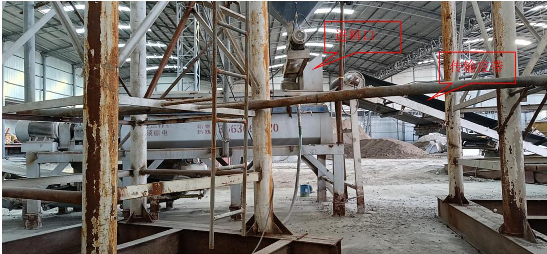
(3) 水泥供给系统：水泥供应商使用密闭罐车运至厂内，使用运输车辆自带气泵，气力运输水泥打入水泥储存罐，上料过程采用密闭管道与水泥储存罐底部进料口相连，杜绝进料口粉尘产生。水泥储存罐顶部呼吸废气经罐顶管道引入“布袋除尘器”TA004处理后，经1根17m高排气筒DA004排放。布袋除尘器除尘灰收集于底部集尘斗，集尘斗内除尘灰直接密闭提升到矿粉仓回用于生产，生产设备运行有噪声产生。
